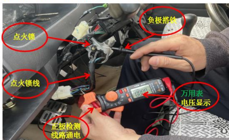
图2:点火信号线、钥匙开关常电线查找：
